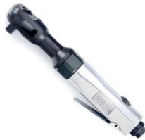
Καστάνια αέρος μισής ίντσας 1/2 160RPM 6.2bar 100Nm 82441 FORCE
