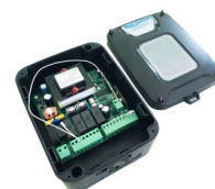
Ηλεκτρονικός πίνακας ελέγχου με ενσωματωμένο δέκτη και κουτί για μοτέρ ανοιγόμενων θυρών 230 Vac S7-150
